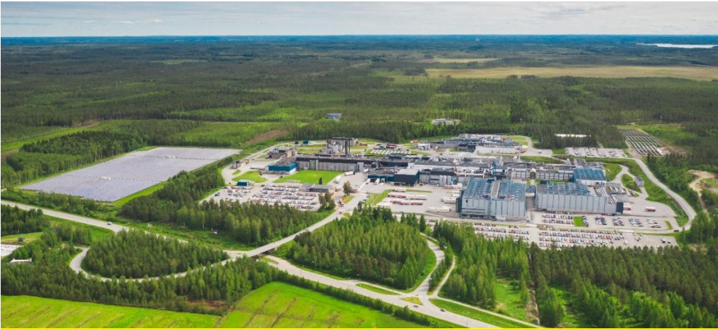
Kuva 2. Kuva Atrian Nurmon tehtaasta, jonka yhteydessä yksi Suomen suurimmista aurinkovoimaloista, mikä tuottaa noin 8% tehtaan sähkön vuosikulutuksesta (Rintamaa, 2021).
