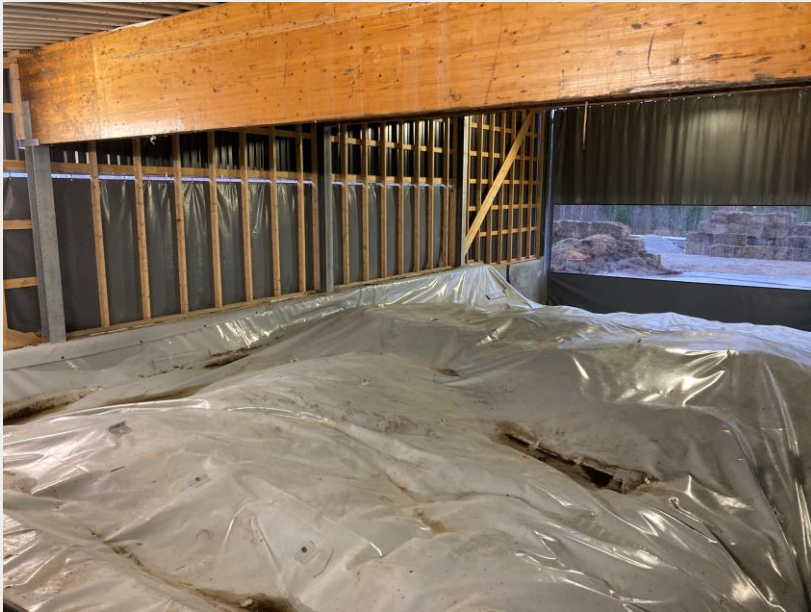
Kuva 2. Myös erätoimisia ja kuivaprosessiin perustuvia mädättämojä on käytössä Suomessa. J. Tiainen 2022.
